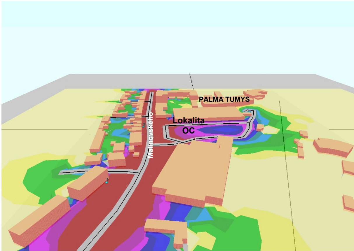
Obr. 4 Vypočítané hlukové pásma L_{Aeq} vo výške 1,5 m nad terénom, delenie pásiem po 5 dB – počas prevádzky OC z cestnej dopravy počas dennej doby – variant A, 3D model
